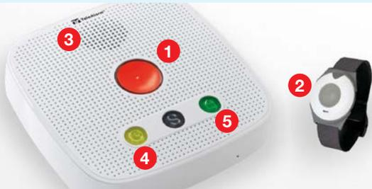
Ein Druck auf die **Notfalltaste** ① oder den **Funksender** ② baut eine direkte Verbindung zur rund um die Uhr besetzten Hausnotrufzentrale auf. Das Gespräch erfolgt über eine integrierte **Freisprecheinrichtung** ③.
